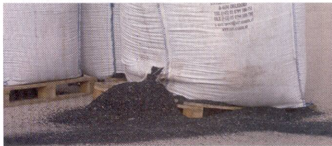
Acht Kilogramm grünes Granulat kommt auf einen Quadratmeter Rasen, damit die Spieler weich laufen können. Die Untergrund-Dämpfung, knapp 81 Tonnen schwarzes Granulat, ist auf dem Kunstrasen der neuen Generation wichtig.
